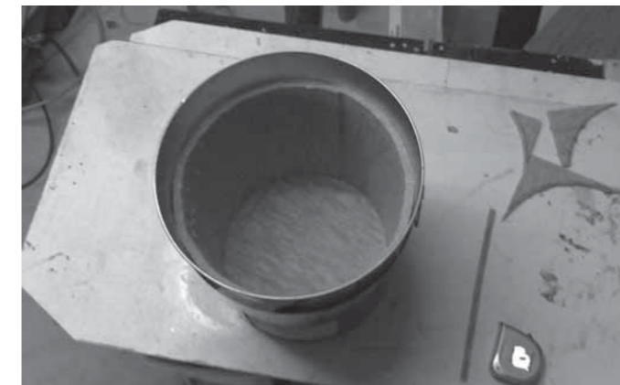
Vaihe 1. Tarvitaan teräspeltinen astia, jonka tilavuus on n. 25 litraa. Sisäpinta vuorataan 10mm paksulla tulenkestävällä mineraalivillalla.
