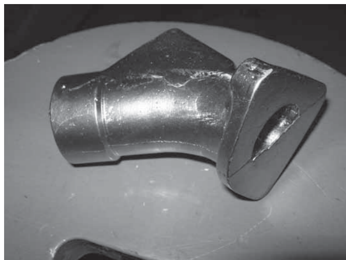
Tilaustyönä teetetty suutinpidin/imukurkku-aiho ennen koneistusta.
