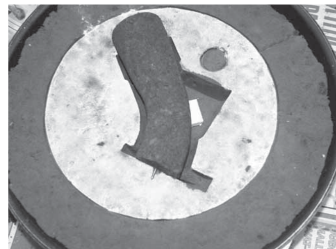
Varsinainen muotti kaavattuna öljyhiekasta ja keerna paikallaan. Kuvassa siis tietysti muotin puolikas. Puolikkaiden välissä toimii irrotusaineena talkki.
