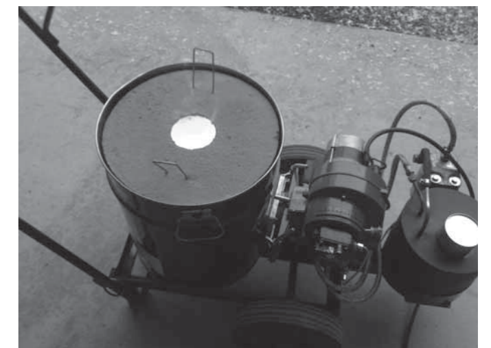
Vaihe 5 ja vaihe 6. Öljypolttimen asennus ja koepolttu sekä uunin asennus soveltuvaan kärryyn. Kuvissa näkyy myös polttimen öljysäiliön sijoitus. Poltin kuluttaa 2 litraa polttoöljyä tunnissa ja tuottaa 20kW nimelistehon.
