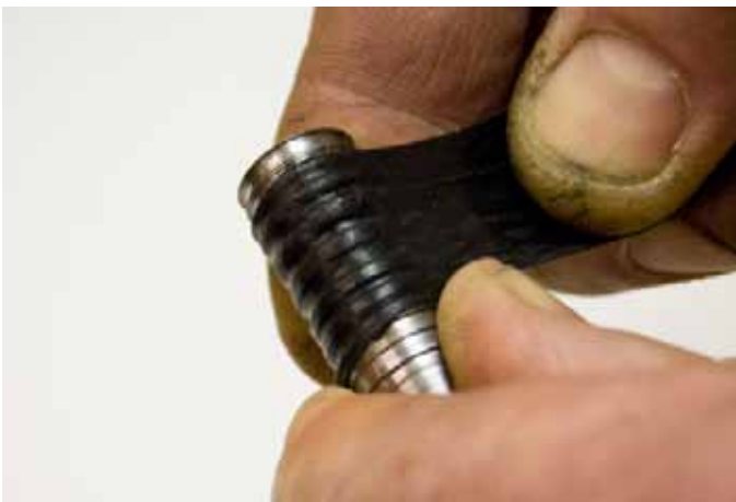
Lehtijousen vaimenninholkin sisäosan ympärille kierretään riittävä määrä kumia. Kumia voi käsitellä kuten eristysnauhaa, koska se on liimautuvaa.
