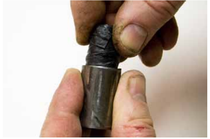
Kumitettu sisäholkki painetaan ulkokuoren sisään.
