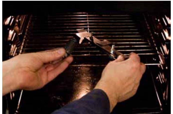
Vulkanoitavat osat asetellaan suoraan uunin ritilälle.
