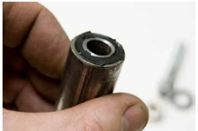
Lehtijousen holkki on valmis asennettavaksi paikoilleen.
