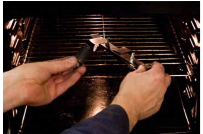
Vulkanoitavat osat asetellaan suoraan uunin ritilälle.
