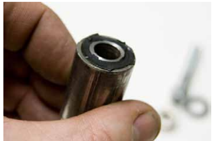
Lehtijousen holkki on valmis asennettavaksi paikoilleen.
