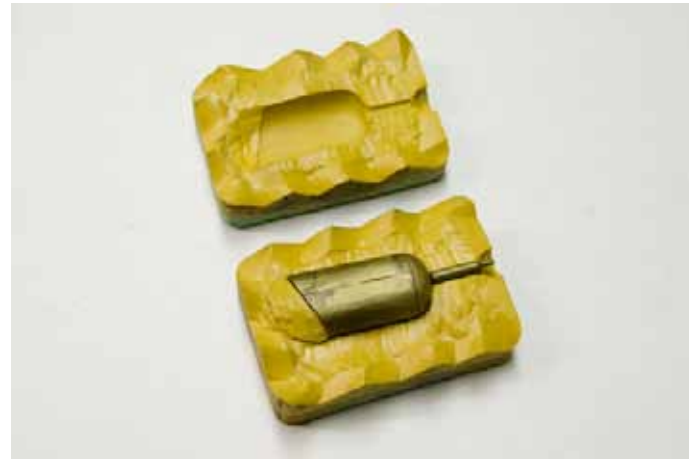
Muottikumi on erittäin tarkasti toistavaa ja kovaa kumia.
