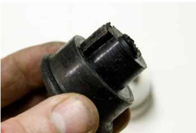
Kumin pinta toistaa tarkasti kaikki muotin muodot.
