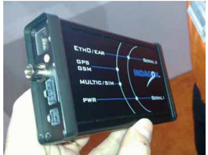
Kuvassa Indagonin valmistama, ajoneuvoon asennettava ITS-boksi.
