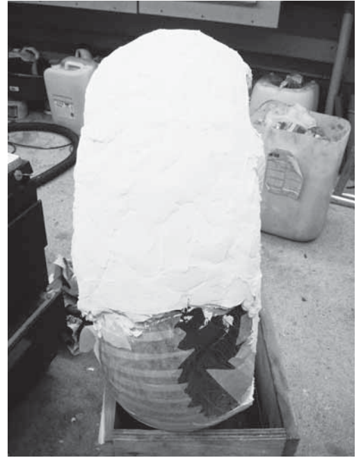
Kuvat 3 ja 4. Muotoa haettiin karkeasti puupalojen ja tavallisen seinätasoiheen avulla. Tasoiheen päälle levitettiin autopakke- liä, hiottiin muotoonsa ja maalattiin. Maalin kuivuttua malli vahattiin useaan kertaan monen päivän aikana.
