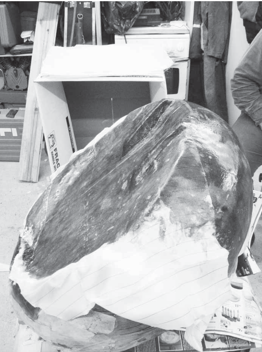
Kuvat 3 ja 4. Muotoa haettiin karkeasti puupalojen ja tavallisen seinätasoiheen avulla. Tasoiheen päälle levitettiin autopakke- liä, hiottiin muotoonsa ja maalattiin. Maalin kuivuttua malli vahattiin useaan kertaan monen päivän aikana.
