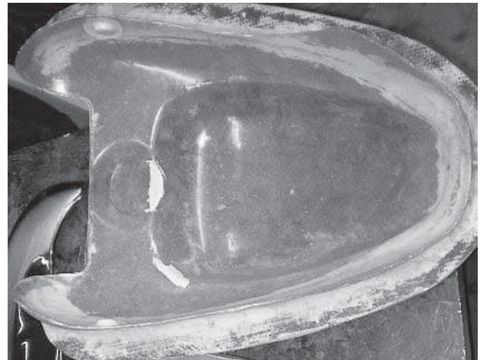
Tyypillinen lasikuidusta ja vanerista valmistettu ulkopuolinen muotti. Huomaa pakkelikorjaukset.
