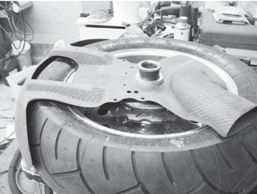
Kuva 8. Lokasuoja on leikattu muotoonsa ja ilmanohjain kiinnitetty. Valmis vietäväksi maa- larille lakattavaksi kaksikomponenttisellä uv- suojalakalla.
