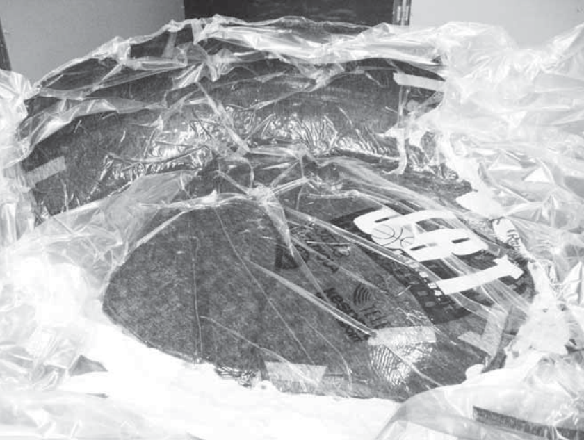
Kuva 6. TukkaJukan T-paita sai hoitaa imukan- kaan virkaa alipainesäkitysvaiheessa. Paita on harmaa mutta vielä sulana virtaava ylimää- räinen hartsi saa sen näyttämään mustalta. Alipainepumppu oli käynnissä seuraavaan iltapäivään asti jolloin säkitys purettiin mutta kappaletta ei vielä irrotettu muotista. Kovetta- mista jatkettiin korotetussa lämpötilassa use- an eri päivän aikana. Vain osittain kovettuneen hiilikuitulaminaatin leikkaus on erittäin vaikeaa ja saattaa syntyä myös delaminaatiota.
