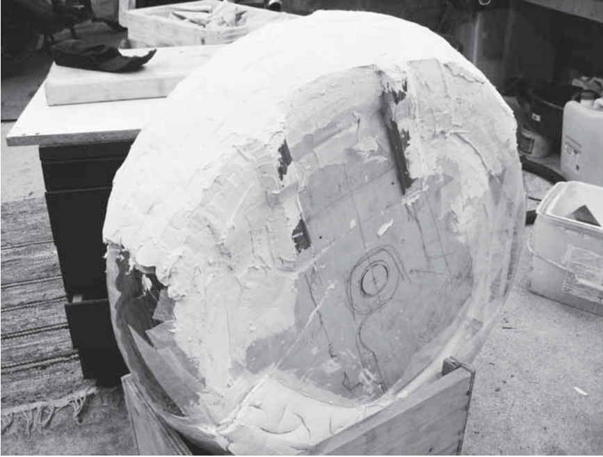
Kuvat 3 ja 4. Muotoa haettiin karkeasti puupalojen ja tavallisen seinätasoiheen avulla. Tasoiheen päälle levitettiin autopakke- liä, hiottiin muotoonsa ja maalattiin. Maalin kuivuttua malli vahattiin useaan kertaan monen päivän aikana.
